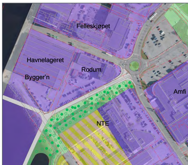
Figur 4-8: Prinsippskisse av 5-arma rundkjøring med ny veg over vestre del av NTEs tomt.
